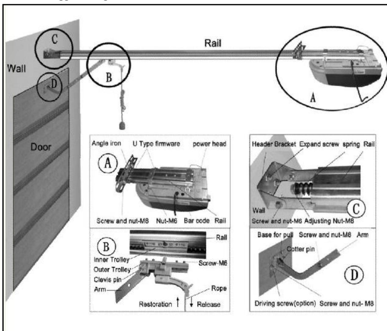
Installare il motore e verificare manualmente che la porta si muova agevolmente sulla guida per tutto il percorso di apertura / chiusura.
